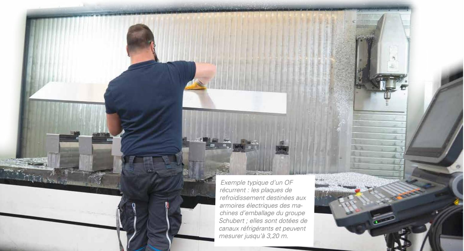
*Exemple typique d'un OF récurrent : les plaques de refroidissement destinées aux armoires électriques des machines d'emballage du groupe Schubert ; elles sont dotées de canaux réfrigérants et peuvent mesurer jusqu'à 3,20 m.*
