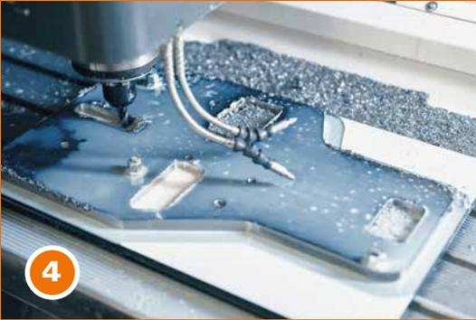
4 Le contour extérieur est fraisé, la surépaisseur éliminée et les zones en bordure cémentées. Les fenêtres de la plaque ne sont volontairement pas découpées au plasma, car l'apport de chaleur qu'implique ce procédé pourrait provoquer des déformations indésirables.
