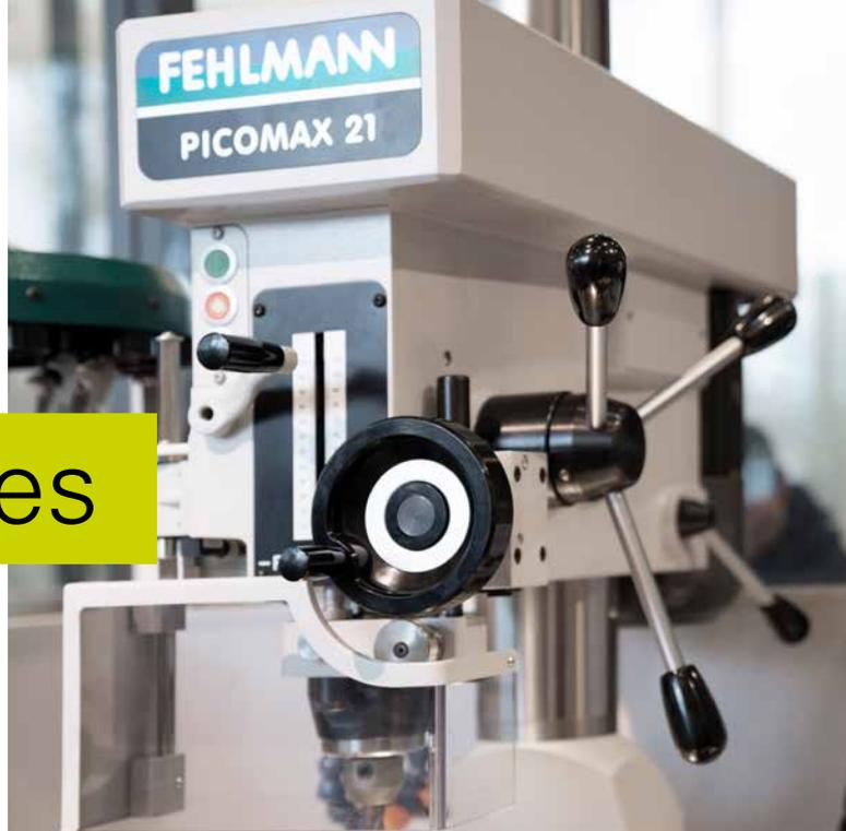
La FEHLMANN PICOMAX 21-M est une machine conventionnelle manuelle. Elle est dotée d'une table motorisée et du POSITIP 8000 ACTIVE, qui lui permettent de se substituer aux machines à CN simples.
