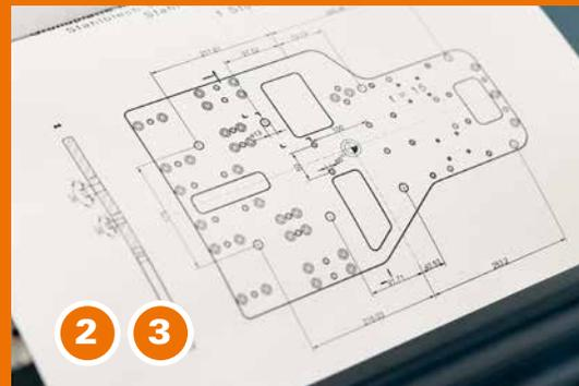
Le support de PC est constitué de deux éléments : un étrier courbe et un système de fixation en trois parties. Jusqu'à maintenant la fixation se faisait par soudure, en deux opérations. Pour cela, deux gabarits étaient nécessaires et il fallait desserrer et resserrer la pièce au moins une fois. Grâce au nouveau gabarit conçu et à ses leviers de serrage associés, toutes les soudures peuvent désormais se faire en un seul serrage.
