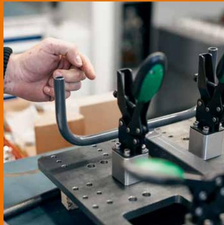
*Configuration-test du gabarit de soudure avec des leviers de serrage à fixation intégrée.*
